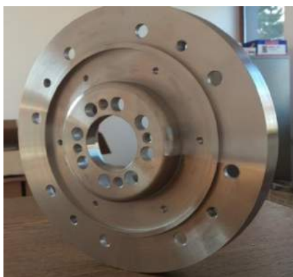
Abb.3 Überprüfte Neuteilqualität auf Maßhaltigkeit mit der 3DLaserScan-Messtechnik
