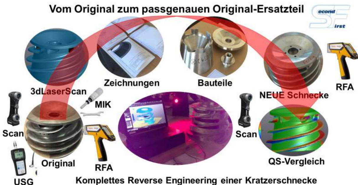
Abb.2: Vom Original zum Original-Ersatzteil mit Digitalem Twin
